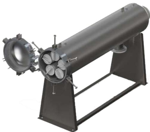
As carcaças HF, utilizadas em conjunto com os elementos filtrantes HF ou HFM, são indicadas para aplicações de alta vazão. São construídas em aço inoxidável 304 ou 316L e suportam pressão de processo de até 10 kg/cm<sup>2</sup>\* a temperatura de até 90°C.
